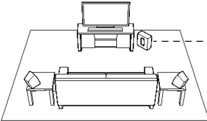
Wenn Sie einen SONOS SUB besitzen, stellen Sie den SUB an einer Stelle auf, an der er am besten in den Raum passt – entweder aufrecht oder flach. Sie können ihn in einer Ecke, an einer Wand, hinter, unter oder neben einem beliebiges Möbelstück auf eine beliebige Bodenoberfläche stellen.
