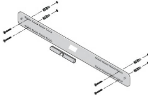
7. Bringen Sie die PLAYBAR-Halterung mithilfe der Schrauben, die im Wandmontage-Kit enthalten sind, an der Wand an. Prüfen Sie die Position ein letztes Mal mit der Wasserwaage, und ziehen Sie dann die Schrauben fest.
