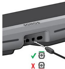
*Die Enden des digitalen Audioeingangskabels und des optischen Kabels der PLAYBAR sind „D-förmig“. Achten Sie auf eine ordnungsgemäße Ausrichtung.*
