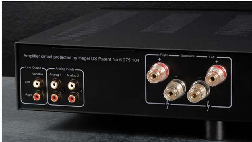
*Lautsprecherterminal und Analog-Schnittstellen des Hegel H90*
