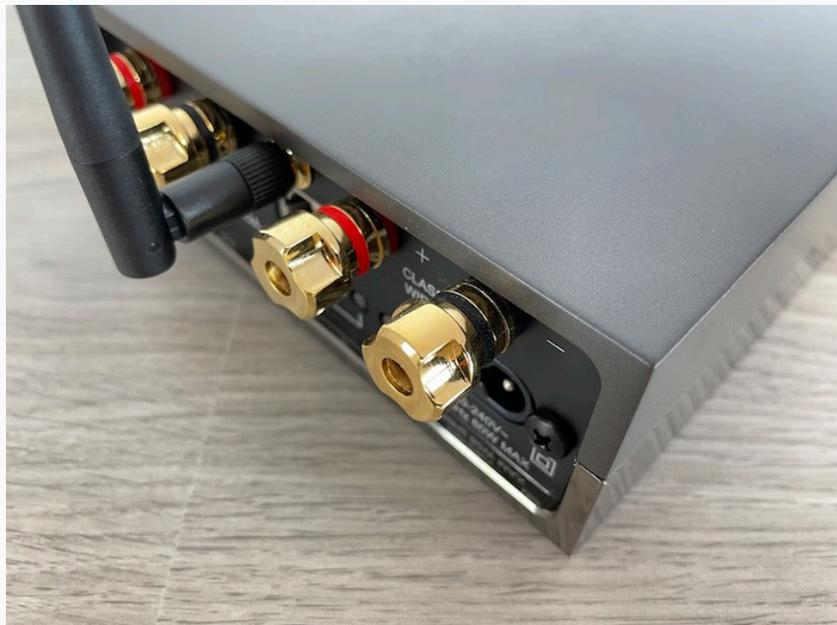
Hervorzuheben sind die sehr hochwertigen Lautsprecherkabel-Anschlüsse
