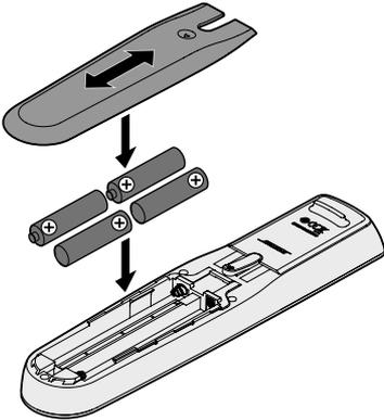
3. Schließen Sie die Batteriefach-Abdeckung wieder.
