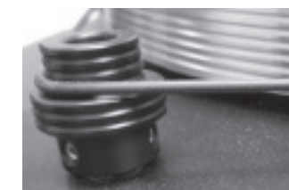
Abbildung 13 - Antriebsriemen in 33-UpM-Stellung
