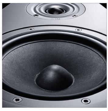
■ Neu entwickelter Tieftmitteltöner mit HECO-Kraftpapiermembran, POC-Staubschutzkalotte (Phase Optimisation Cap) und verlustarmer Gummisicke im stabilen Aludruckgusskorb
