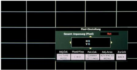
Die **Konvergenz** kann in UHD-Pixelsschritten angepasst werden. Das ist sowohl für das gesamte Bild möglich, als auch für kleine Bereiche.
