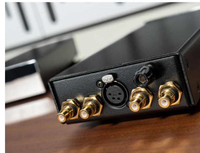
*Das Audio-Teil ist mit ausgezeichneten Buchsen bestückt. Sie sind kanalweise angeordnet: Links sitzen die Ein- und Ausgänge des linken Stereo-Kanals, rechts, wo auch die schwarze Schraubklemme für die Erdung platziert ist, finden wir die Ein- und Ausgänge des rechten Stereo-Kanals. In der Mitte ist die vierpolige XLR-Buchse zum Anschluss des Netzteils zu sehen.*
