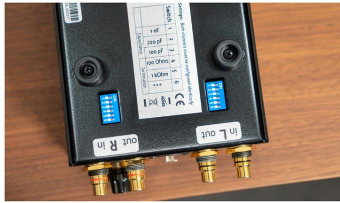
*MM- und MC-Anpassung: Auf der Unterseite des Audioteils sind zwei blaue Mäuseklaviere eingelassen. Mit diesen DIP-Schaltern kann man die Kapazität und den Widerstand verändern. So erreicht man optimale Arbeitsbedingungen für das Abtastsystem des Plattenspielers.*
