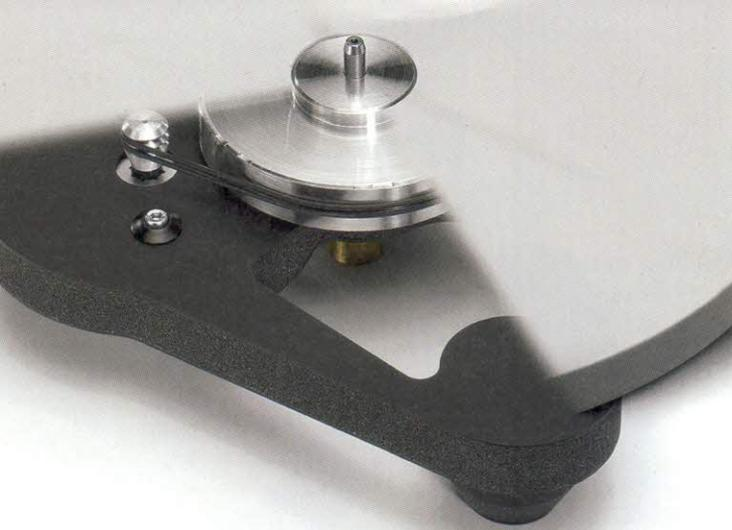
Oben links: Der schneeweiße Teller besteht wie die obere der beiden Versteifungsbrücken zwischen Tonarm und Tellerlager aus Keramikoxid, welches eine sehr hohe Steifigkeit bei sehr geringer Masse aufweist. Modifiziert wurde der Übergangsbereich zwischen Teller und Subteller gegenüber dem Vorgänger RP10. Die mittelgroße Tellermasse ist so weit wie möglich am Außenrand konzentriert
